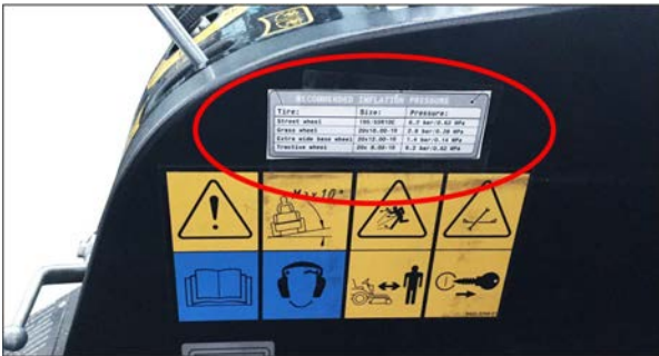
Figura: Autocolante na cabina do condutor com pressão recomendada para os pneus
